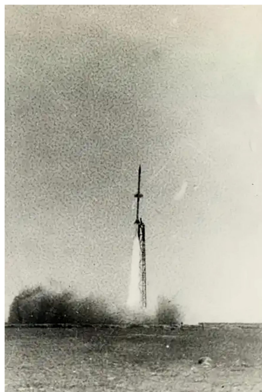
1958年秋，由北京工业学院研制的新中国第一枚二级固体燃料探空火箭发射瞬间
